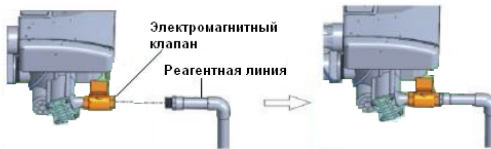
Рисунок 4 — Подключение реагентной линии в установке WS-34,0-Rx-(BS)
